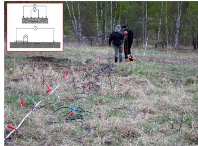
Kuva 12. Kaaviossa Wenner mittausjärjestelmä ja monielektrodigradianttimitausjärjestelmä. Valokuvassa monielektrodivastusluotaus Suurpellon alueen eteläpäässä. Mittauksessa maadoitetaan elektrodit suoraan linjaan 1-5 metrin välein. Menetelmällä saadaan hyvin tarkka kuva maaperän sähkönjohtavuuden vaihteluista 15-50 metrin syvyyteen elektrodivälillä riippuen.
