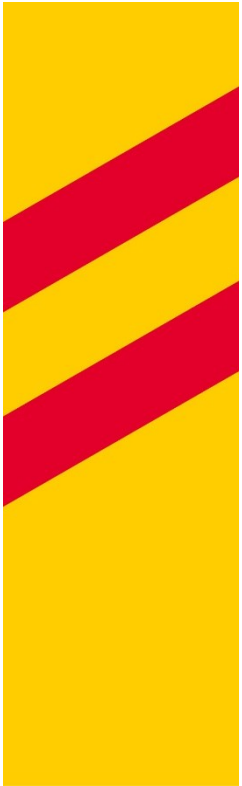
Infartsmärke för plankorsning med järnväg (näst närmast plankorsningen)
