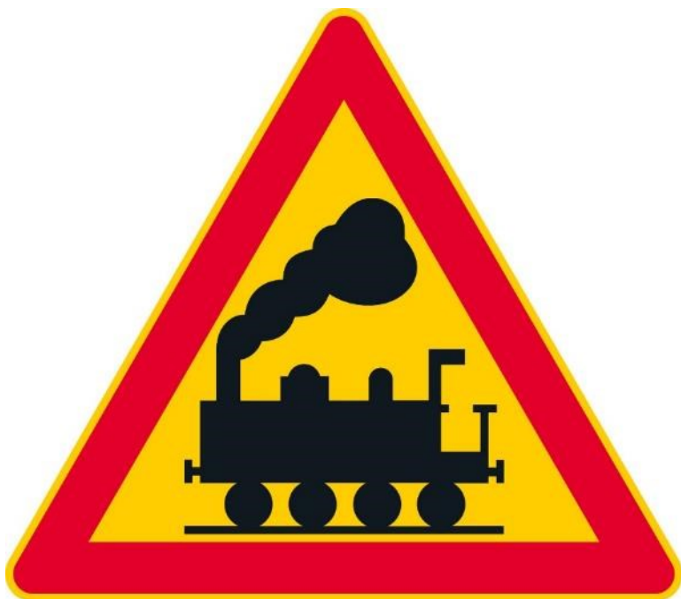
Plankorsning med järnväg, utan bommar
