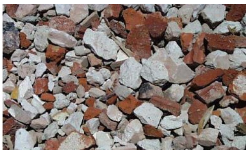
Tiilimurske (kuva: Tero Elo 1999)
