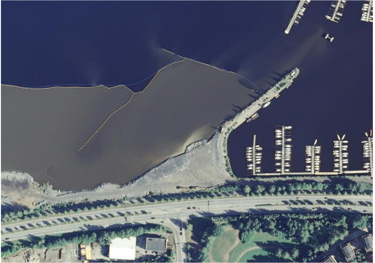
Kuva 5.2. Ilmakuva Ranta-Tampellan vesistötäytöstä ja suojaverhosta keskikesällä 2014. © www.karttaikkuna.fi . Samentunutta vettä pääsi kuvaushetkellä kulkeutumaan pintavirtauksena suojaverhon yli satama-allasta kohti. Ero suojaverhon sisä- ja ulkopuolen välisessä sameustasossa oli kuitenkin edelleen selvä.
