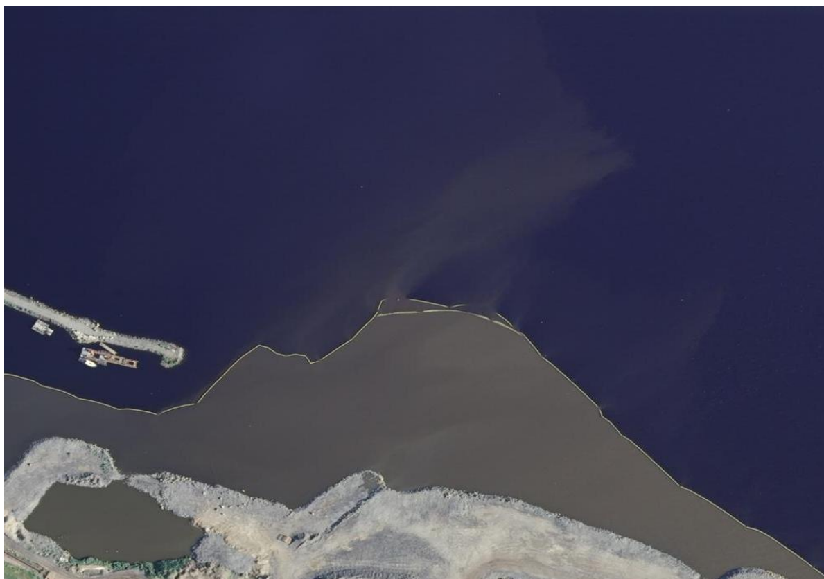
Kuva 5.1. Ilmakuva Santalahden vesistötäytöstä ja suojaverhosta keskikesällä 2014. © www.karttaikkuna.fi . Samentunutta vettä pääsi kuvaushetkellä kulkeutumaan pintavirtauksena suojaverhon yli. Ero suojaverhon sisä- ja ulkopuolen välisessä sameustasossa oli kuitenkin edelleen selvä.
