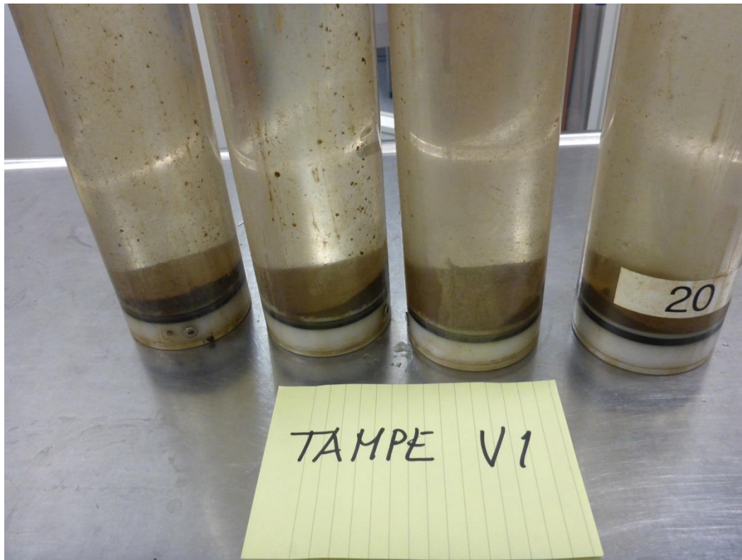
Kuva 4.25. Ranta-Tampellan vesistötäytön suojaverhon edustan sedimentaatiokeräimen putkiin kertynyttä ainesta toisen inkubaatiojakson aikana.
