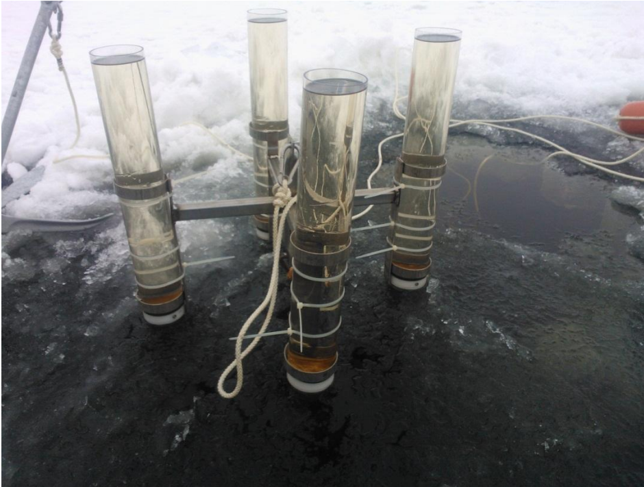
Kuva 3.1. Rantatunnelin rakentamiseen liittyvien vesistötäyttöjen sedimentaatioseurantaan käytetty näytteenottokalusto.
