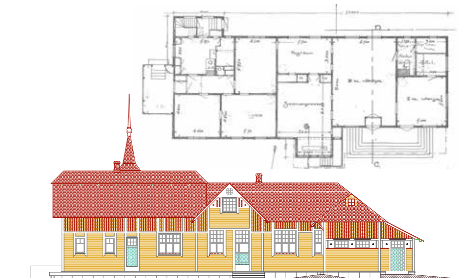
Kauniaisten aseman julkisivujen entistämisuunnitelma ja asemarakennuksen alkuperäinen pohjapiirros.
