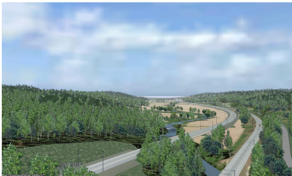
Kuva 22. Ote virtuaalimallista. Espoonjoen ylityksen kohdalla uudet ja vanhat raiteet kulkevat noin 40 metrin päässä toisistaan. Uudet raiteet sijoittuvat nykyiselle peltoalueelle.
