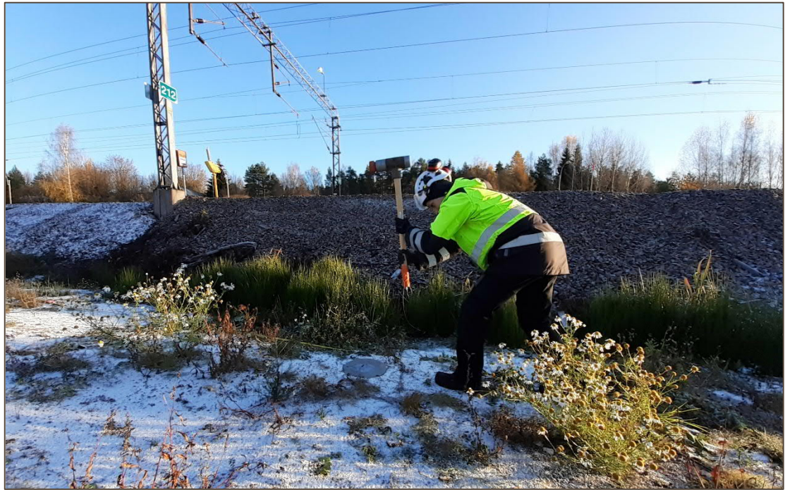
Kuva 4. Siirtomobiliiteetti ja maaperän karakterisointimittauksissa värähtelyn keinoherätteenä käytettiin impulssilekaa.
