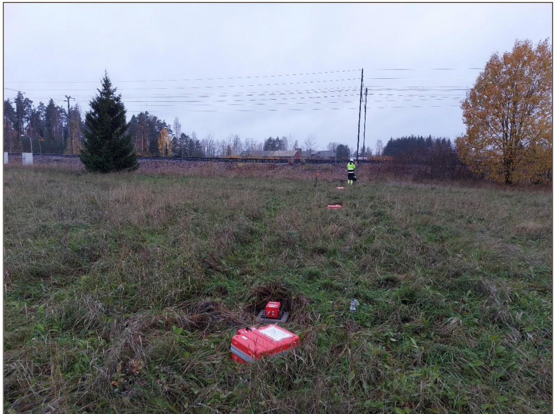
Kuva 3. Mittausjärjestelyt mittauslinjalla K2L1. Junien aiheuttamaa värähtelyä sekä maaperän värähtelyominaisuuksia mitattiin rataa vasten kohtisuorilla linjoilla, enimmillään noin 40 m etäisyydellä radasta.
