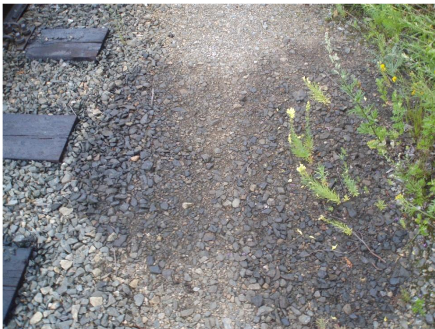
Kuva 3: Suunnittelualueen maaperän pintakerroksessa todettiin paikoin pieniä merkkejä mahdollisista öljyvuoodoista myös raiteiden ulkopuolella.
