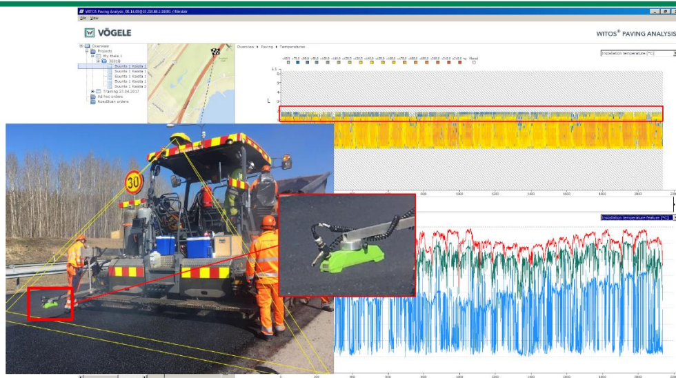
Kuva 13. Esimerkki analyysistä - Lämpötilat
