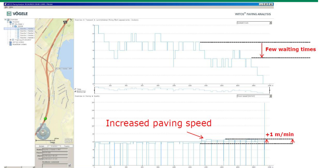
Kuva 14. Esimerkki analyysistä – odottavat autot
