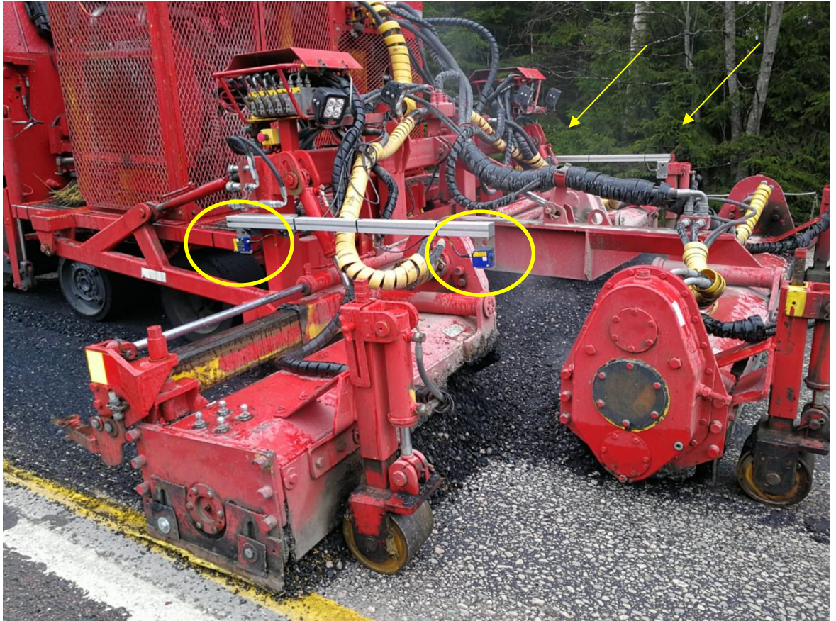
Kuva 1. MPKJ:työn jyrsimessä käytetyn laitteiston sijainnit
