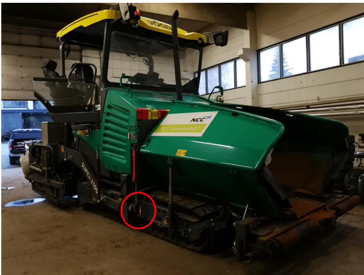
Kuva 3. Lämmitetyn alustan lämpötilan mittaaminen
