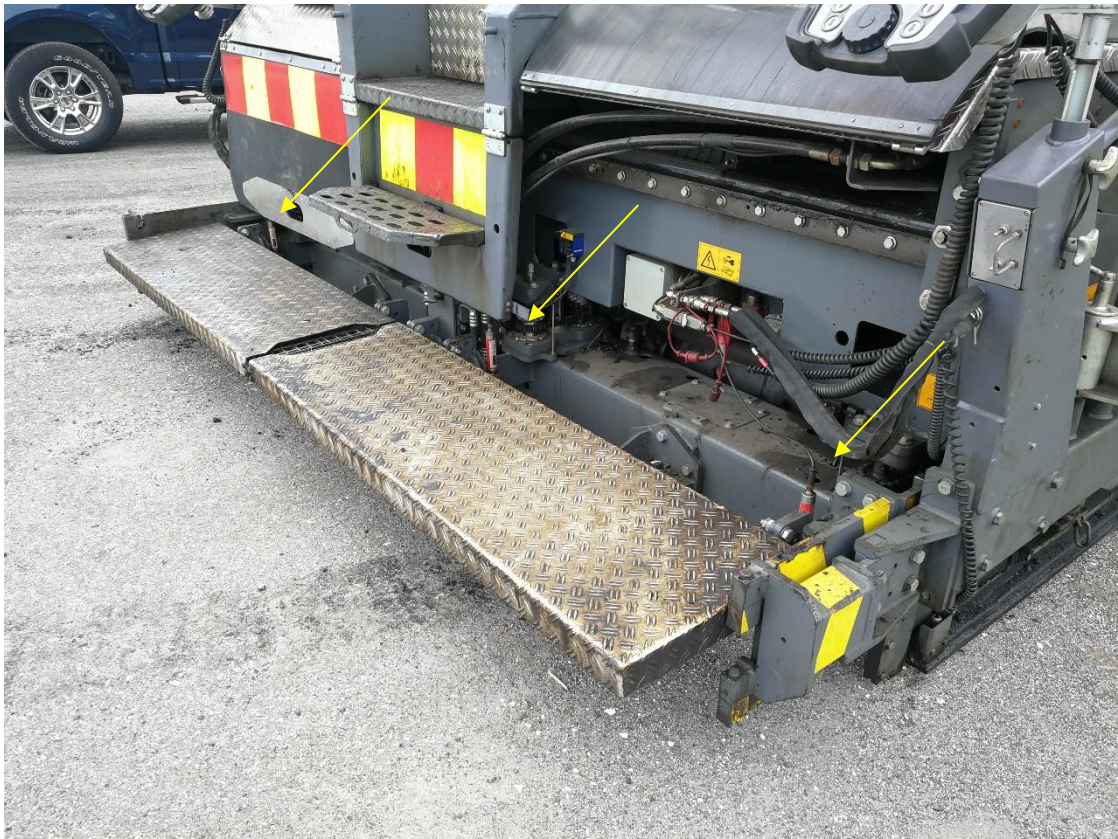
Kuva 4. Lämpötila-antureiden sijainti levittäjän perässä
