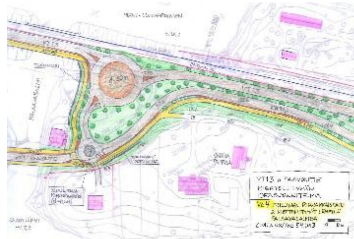
Kuva 38. HYLÄTTY VE: kuten ve 2, mutta kiertoliittymä lähellä Palaavasalmee ja rinnakkaiskatu etäämmällä pappilan mäestä (ve 4).
