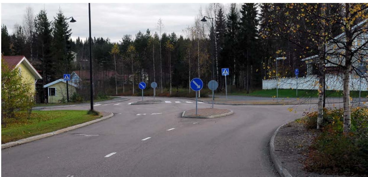
Kuva 22. Miniporrastus siirtää suoraan jatkettaessakin ajolinjaa sen verran, että täytyy hidastaa. Jyväskylä (TV)
