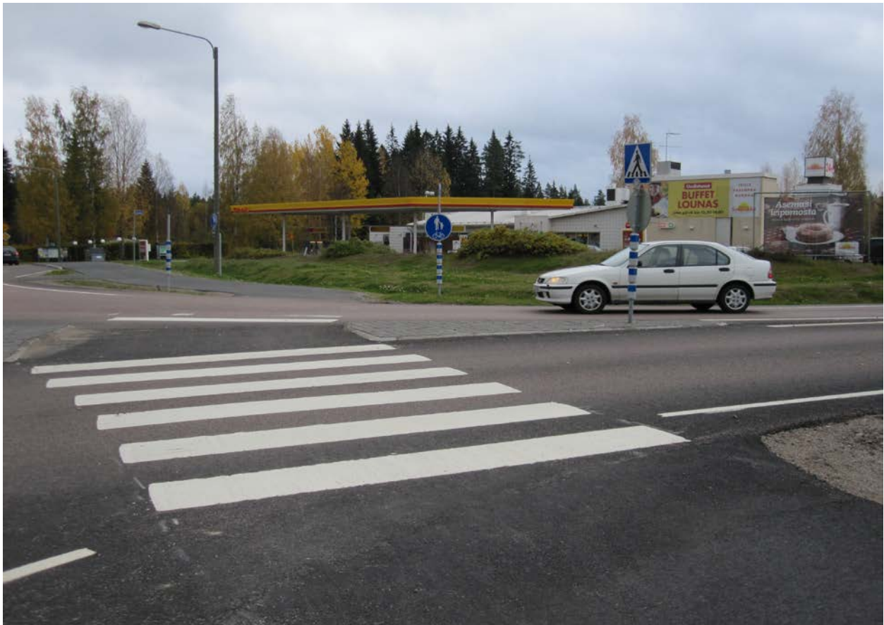
Kuva 27. Vt 4 ja kt 69 liittymässä Hirvaskankaalla pyöräilijät joutuvat hieman muuttamaan kulkulinjaansa, jolloin vauhti hidastuu ja ylitys on paremmin kohtisuorassa ajorataan nähden. Ajoradan risteyskohdassa ei ole reunakivikynnyksiä, joten hidastamista ei koeta epämiellyttäväksi ja kulkijan huomio kiinnittyy paremmin liikenteeseen eikä reunakiven matalimman kohdan etsimiseen. (AMP)
