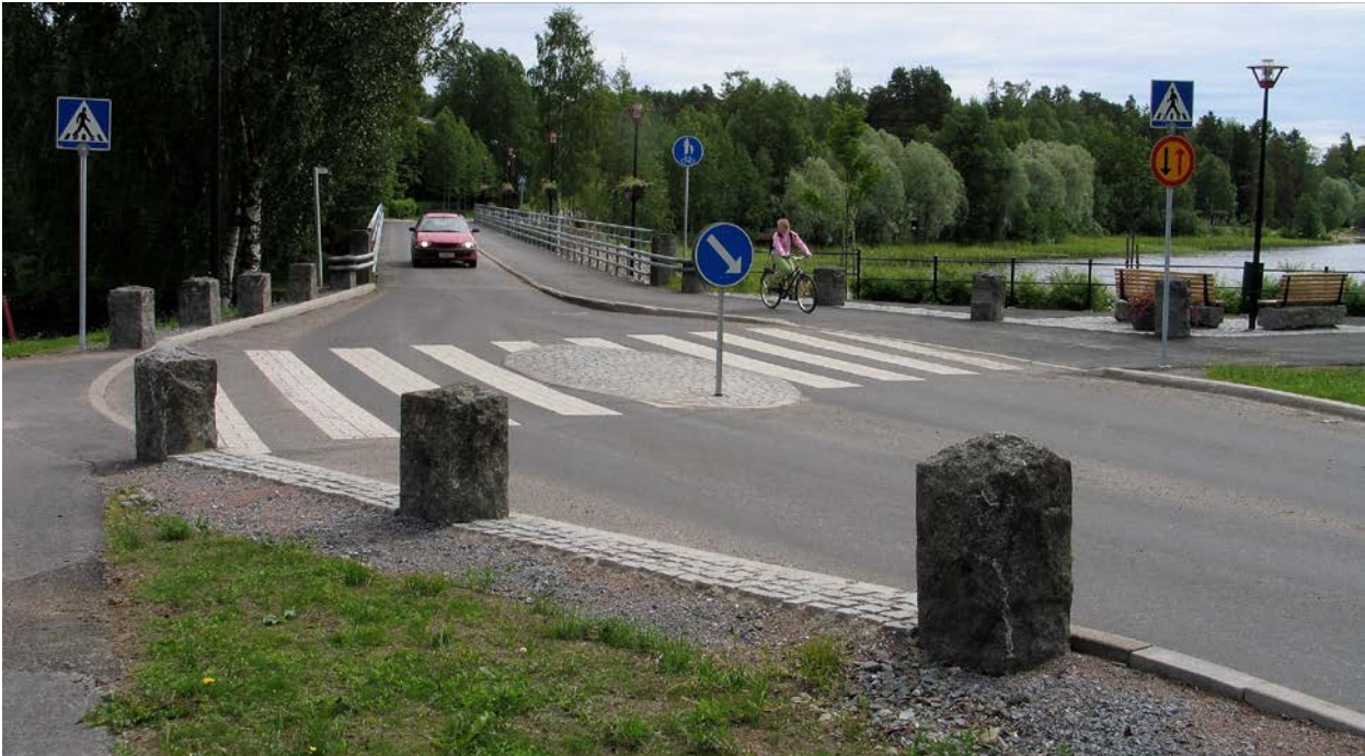
Kuva 33. Moottoriajoneuvoliikenteen nopeus hidastetaan tehokkaasti keskisaarekkeella ennen kapealle sillalle ajoa, Keuruu. (TV)
