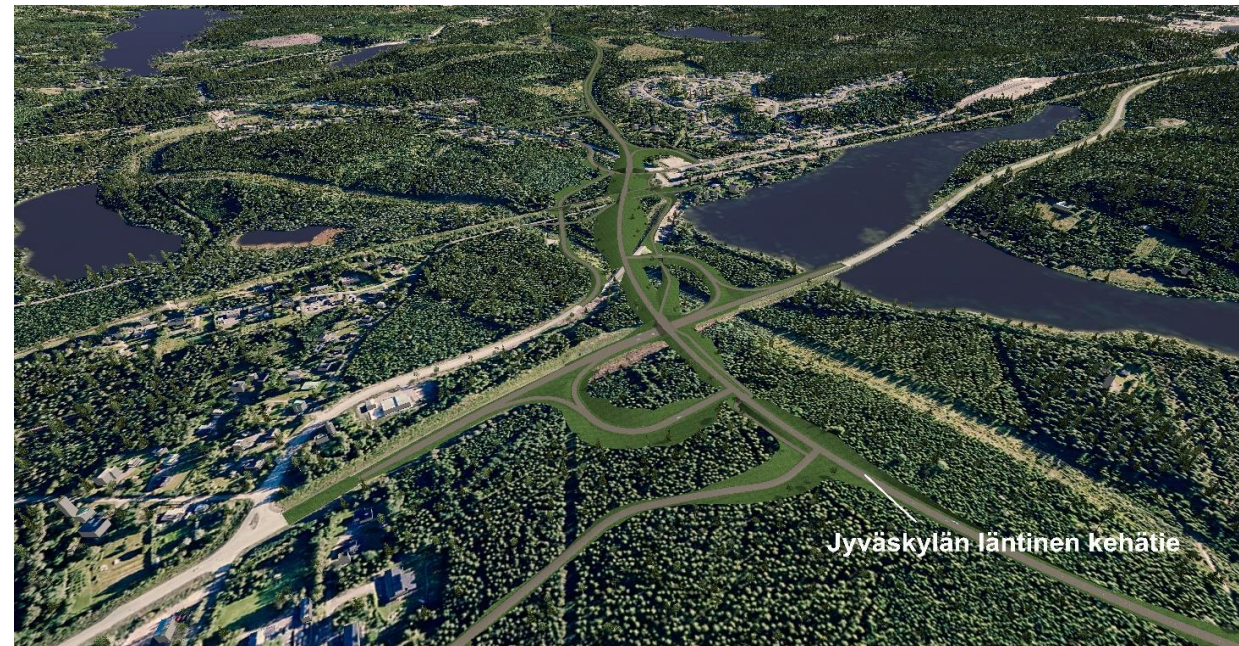
Kuva 26. Valittu liittymävaihtoehto valtatielle 18.
