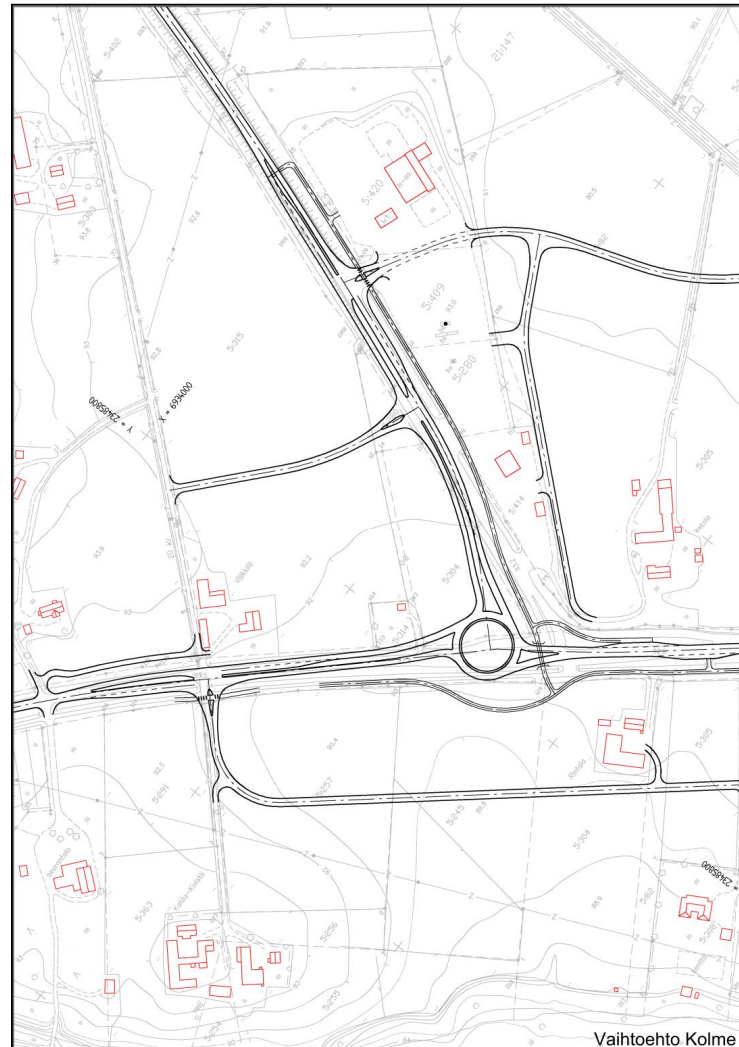
Kuva 6. Kolmihaaraisen kiertoliittymän periaateratkaisu
