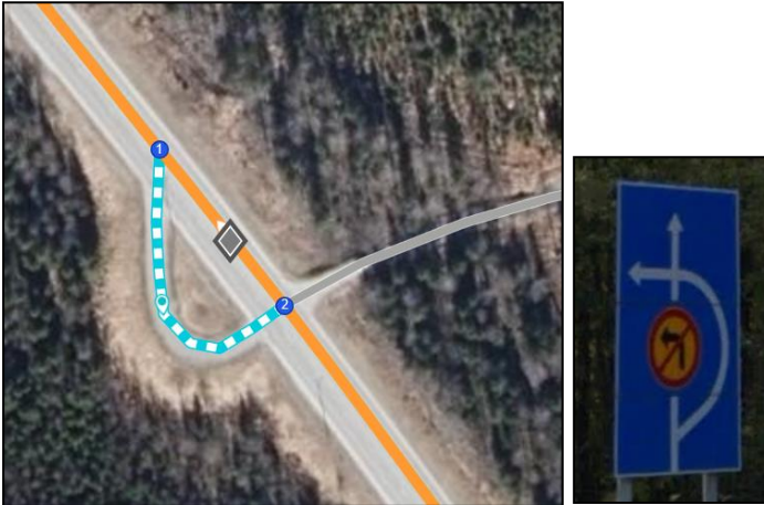
Kuva 22: Silmukkakäännös, ns. espanjalainen silmukka. Päätiellä on kääntymiskielto vasemmalle ja ajo vasemmalle tapahtuu oikealla sijaitsevan odotustilan kautta. Kohde on osoitettu aina kuvan liikennemerkillä.
