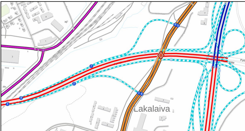
Kuva 17. Solmuun liitetään vain ne rampit ja liittymät joiden kautta on kulku ko. risteävälle tielle
