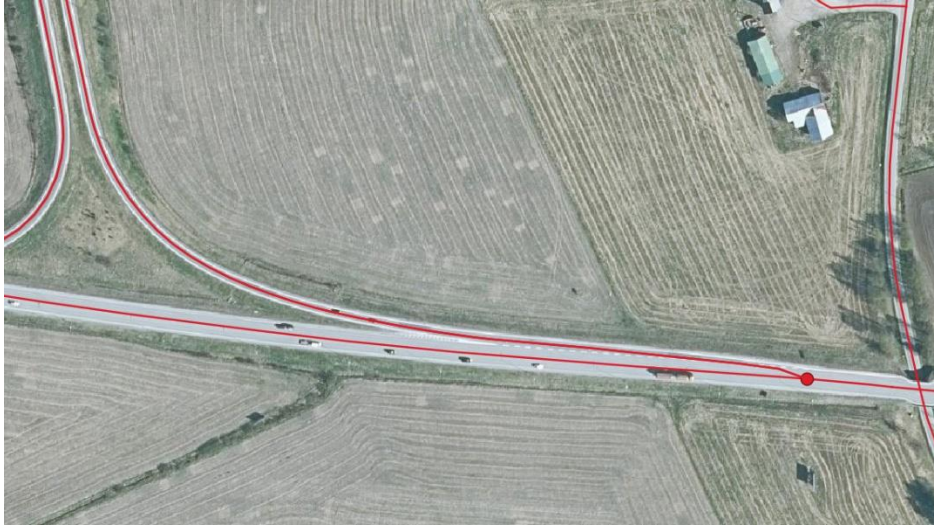
Kuva 10. Katko sijoitetaan liittymis- tai erkanemiskaistan päähän
