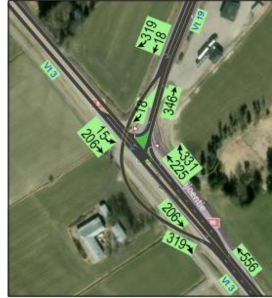
Simulaatiotarkasteluissa käytetyt liikennemäärät vuoden 2040 iltahuipputunnille
