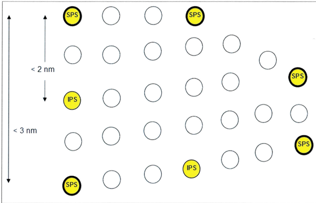
Kuva 6 Esimerkki tuulivoimapuiston merkitsemisestä (IALA recommendation, The marking of offshore man-made structures, 2021). Nurkkavoimaloiden (SPS) väliltä voidaan lisäksi merkitä yksittäisiä voimaloita (IPS), joiden valotunnusten on poikettava selvästi nurkkavoimaloiden valotunnuksista.
