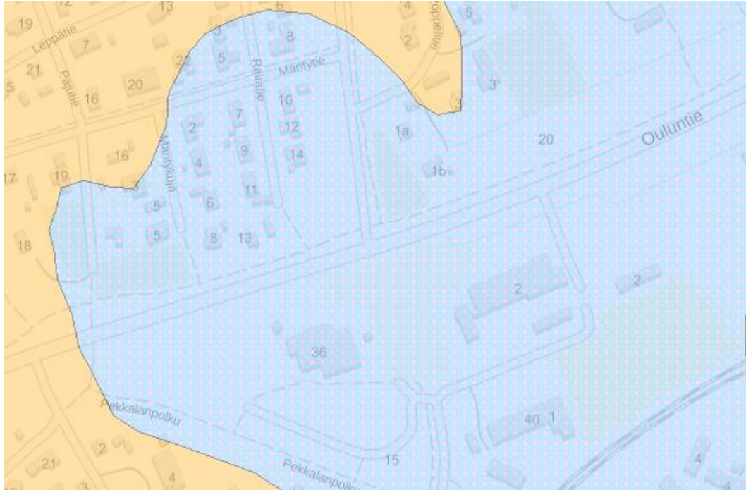
Kuva 10 Ote maaperäkartasta (Geologian tutkimuskeskus, karttapalvelut). Suunnittelualueella maaperä koostuu savesta ja siltistä (sininen alue) ja moreenista (keltainen alue).
