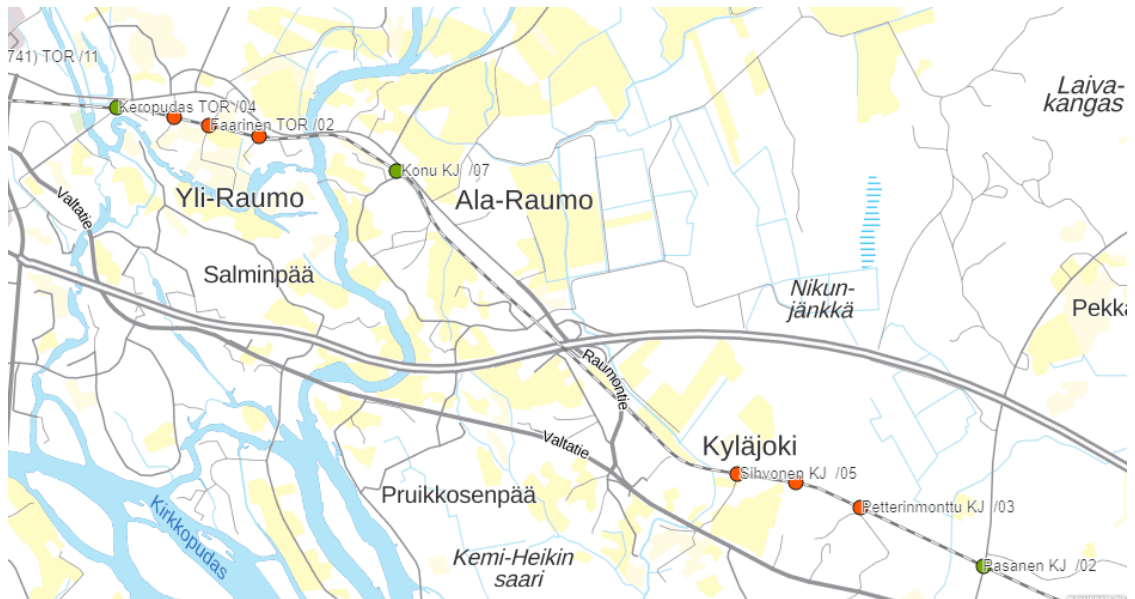
Kuva 2. Laurila - Tornio Itäinen rataosalla sijaitsevat tasoristeukset välillä Pasanen - Keropudas.
