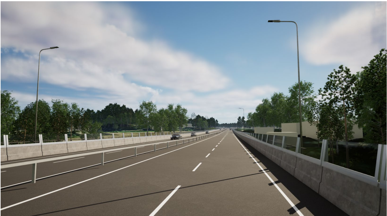
Kuva 65. Melukaiteet voidaan tehdä yläosastaan läpinäkyviksi, jolloin niiden näkymiä katkaiseva vaikutus jää vähäisemmäksi
