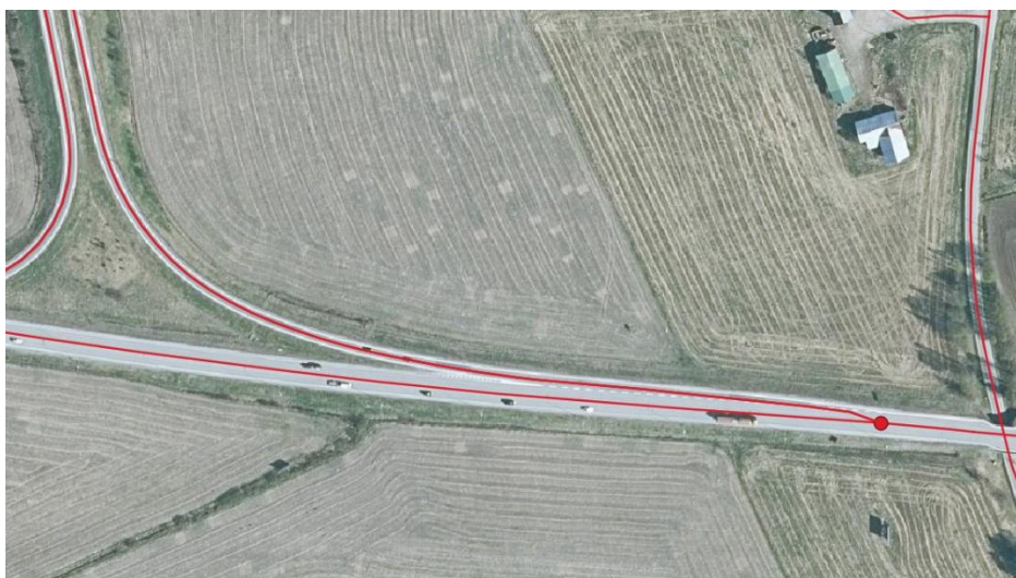
Kuva 9. Katko sijoitetaan liittymis- tai erkanemiskaistan päähän
