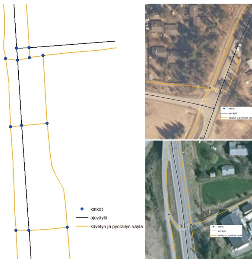
Kuva7. Kävelyn ja pyöräilyn väylän yhteys muodostetaan suojatien kohdalle, mikäli pääväylän toisella puolellakin jatkuu kävelyn ja pyöräilyn väylä. Myös pysäkillä muodostetaan oma yhteys (katso myös alla kuva 9).
