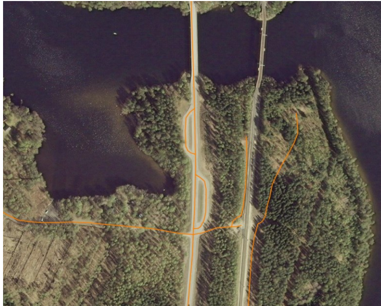
Kuva 36. Lenkki erottuu ajoväylästä fyysisellä esteellä. Levike mallinnetaan omana viivana.
