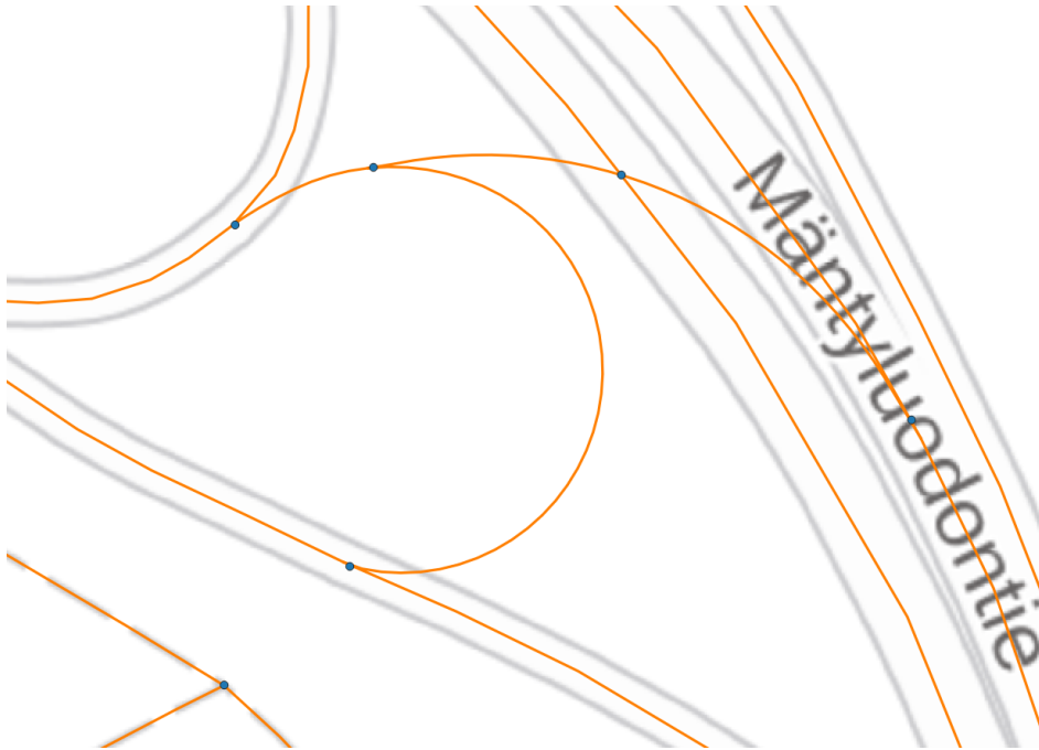
Kuva 43. Ainoastaan erikoiskuljetuksen käyttöön suunnitellut rampit mallinnetaan mukaan SURAVAGE aineistoon.
