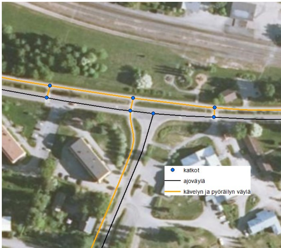
Kuva 9. Suojatien yhtymäkohdat tonteille tai pihoihin piirretään myös omana geometriana, mikäli kulkuyhteys erottuu erillisenä haarana.
