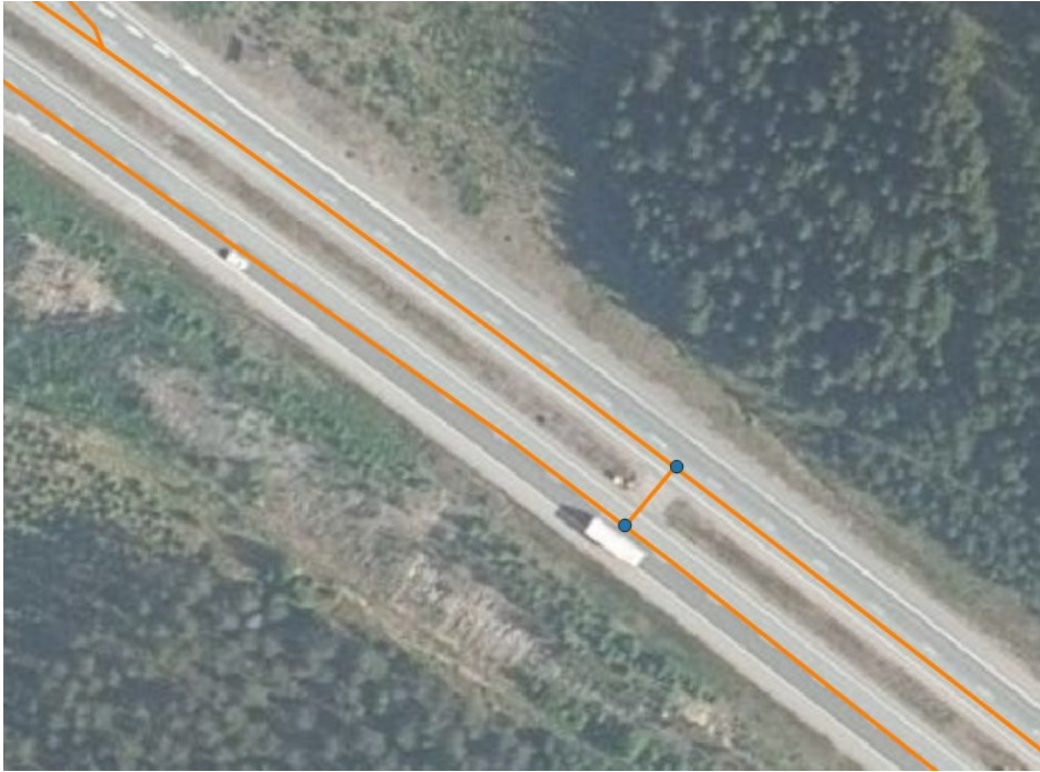
Kuva 34. Huoltoaukon geometria kuvattuna kaksisuuntaisena moottori- tiellä.
