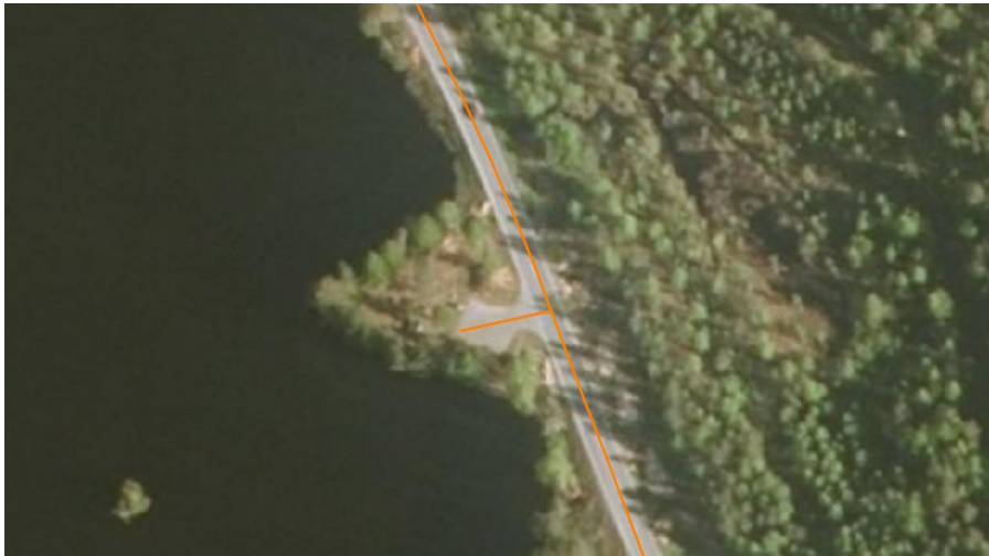
Kuva 40. T-mallin levikkeessä geometria mallinnetaan pistona ajoväylästä alueen päähän.
