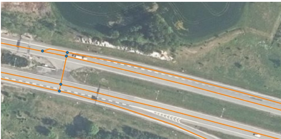
Kuva 35. Huoltoaukko yhdistetty myös rampin geometriaan.
