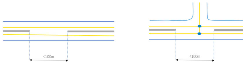
Kuva 6. Kaksiajorataisen osuuden keskellä oleva, maksimissaan 100m pitkä yksiajoratainen osuus yleistetään kaksiajorataosuudeksi. Kuvassa vasemmalla esimerkki, jossa ajoratojen välisessä fyysisessä esteessä on aukko ja oikealla esimerkki, jossa risteyskohdalla ei ole fyysistä estettä.
