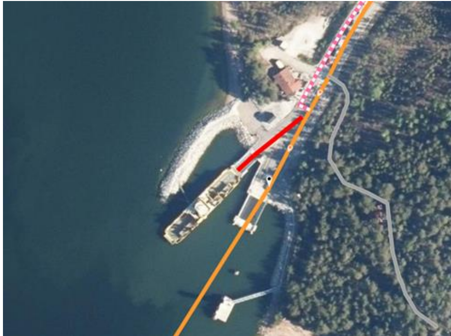
Kuva 43. Jos laituri on erillinen ja sinne johtaa oma tie niin sille tehdään oma geometria (haara). Kuvan erillisessä laiturissa lautta on kiinnittyneenä.
