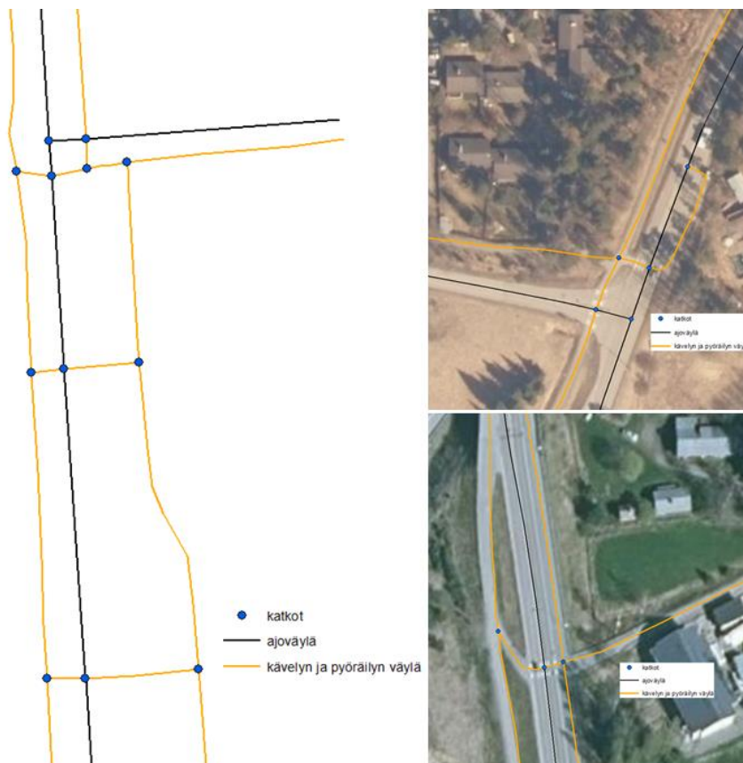
Kuva7. Kävelyn ja pyöräilyn väylän yhteys muodostetaan suojatien kohdalle, mikäli pääväylän toisella puolellakin jatkuu kävelyn ja pyöräilyn väylä. Myös pysäkkille muodostetaan oma yhteys (katso myös alla kuva 9).
