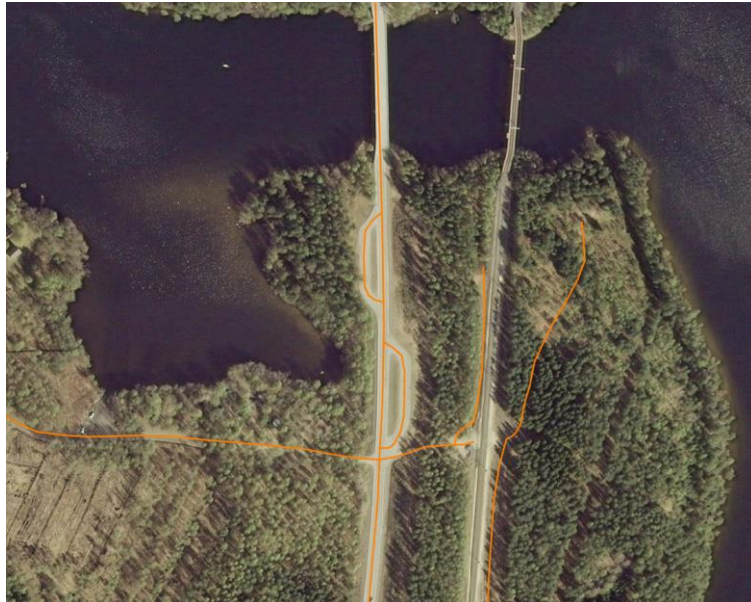
Kuva 35. Lenkki erottuu ajoväylästä fyysisellä esteellä. Levike mallinnetaan omana viivana.
