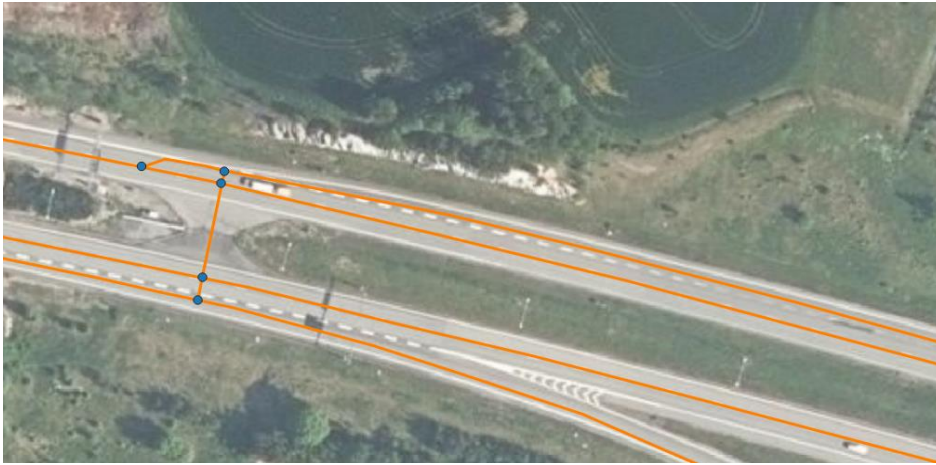
Kuva 33. Huoltoaukko yhdistetty myös rampin geometriaan.
