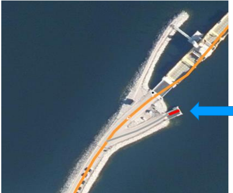
Kuva 41. Tien geometriaa jatketaan laiturin päähän asti, mikäli se ei jatku lautta- väylänä.
