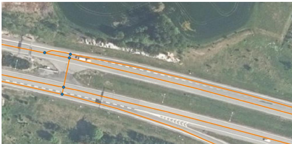
Kuva 33. Huoltoaukko yhdistetty myös rampin geometriaan.
