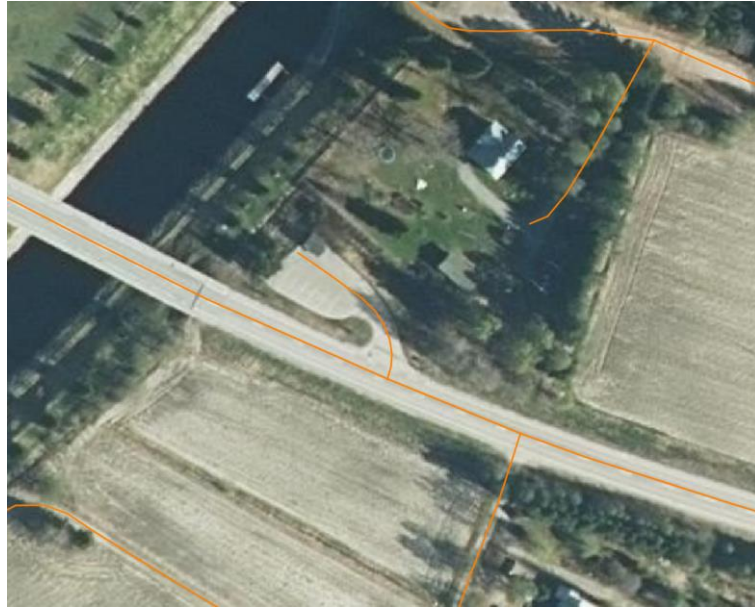
Kuva 38. Pussimallin levähdysalueella viiva viedään alueen päähän saakka.
