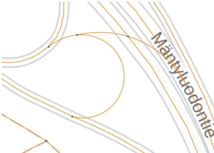
Kuva 46. Ainoastaan erikoiskuljetuksen käyttöön suunnitellut rampit mallinnetaan mukaan SURAVAGE aineistoon.
