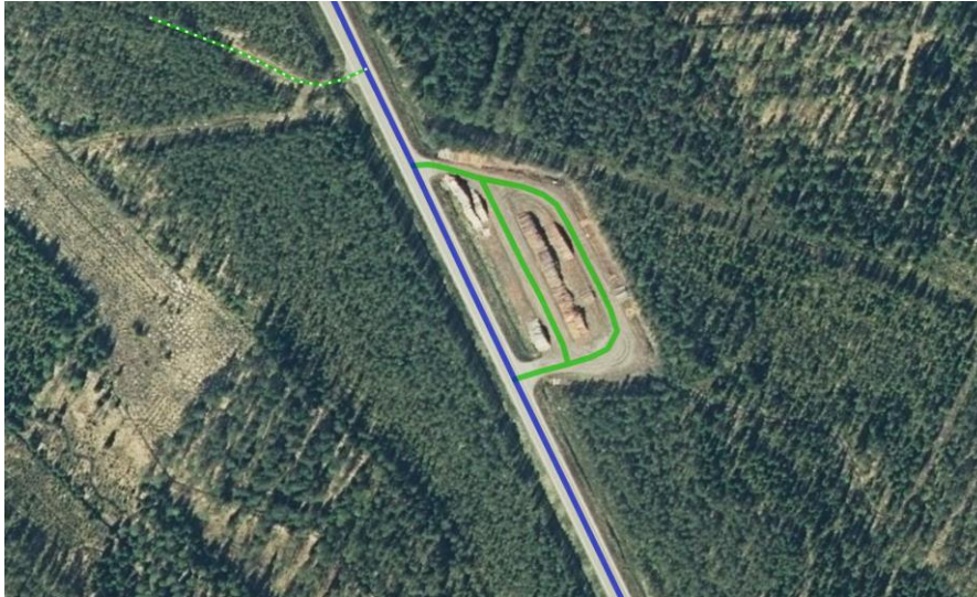
Kuva 40. Kuormaus- ja lastausalueen ajoreitit kuvataan omina viivoina.
