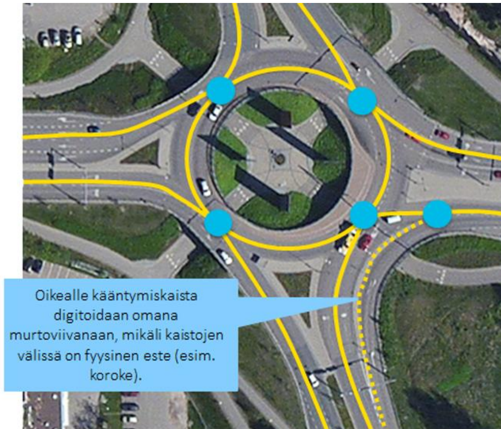
Kuva 23. Kiertoliittymä, jossa oikealle käänntyvät pääsevät ohittamaan kiertoliittymän (=vapaa oikea). Huom! käänntyvää kaistaa ei digitoida omana geometrianaan, mikäli kaistojen välissä ei ole fyysistä estettä.
