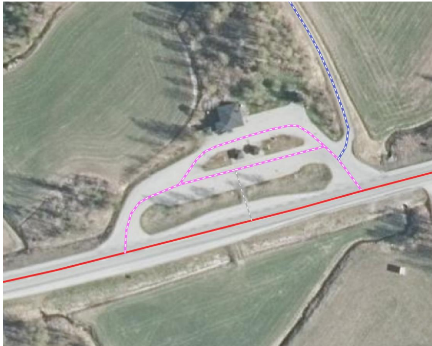
Kuva 37. Levähdysalueen sisällä oleva erillinen ajoreitti mallinnetaan omana viivana.
