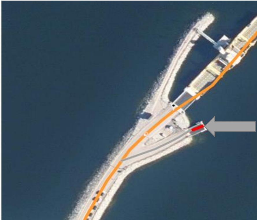
Kuva 41. Tien geometriaa jatketaan laiturin päähän asti, mikäli se ei jatku lauttaväylänä.
