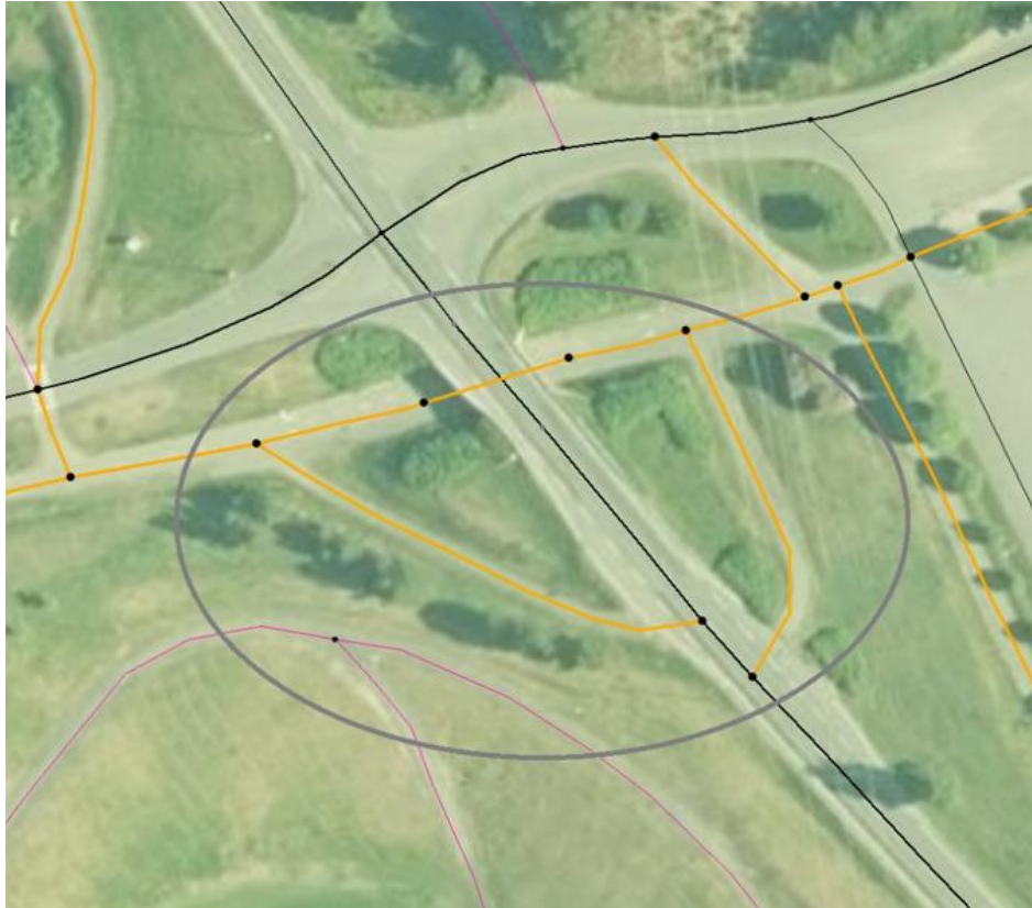
Kuva 10. Pysäkin ja kevyen liikenteen välinen yhtymäkohta liitetään ajoväylään.
