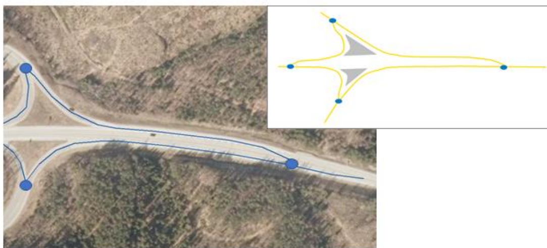
Kuva 15. Suuntaisliittymä ("kalanpyrstöramppi"): Haaraumien yhteydessä olevien kiihdytys-/jarrutuskaistaramppien keskilinjat kuvataan kuten muutkin rampit eli keskilinja alkaa kohdasta, josta ramppi maastossa fyysisesti alkaa.
