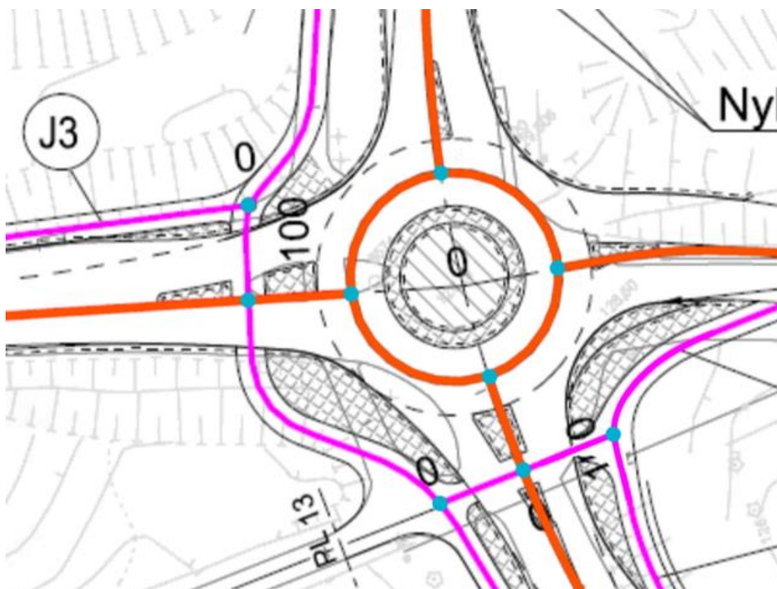
Kuva 22. Kiertoliittymästä kuvataan ajoradan keskilinjan säde. Kiertoliittymän keskiliinja kuvataan myös murtoviivana
