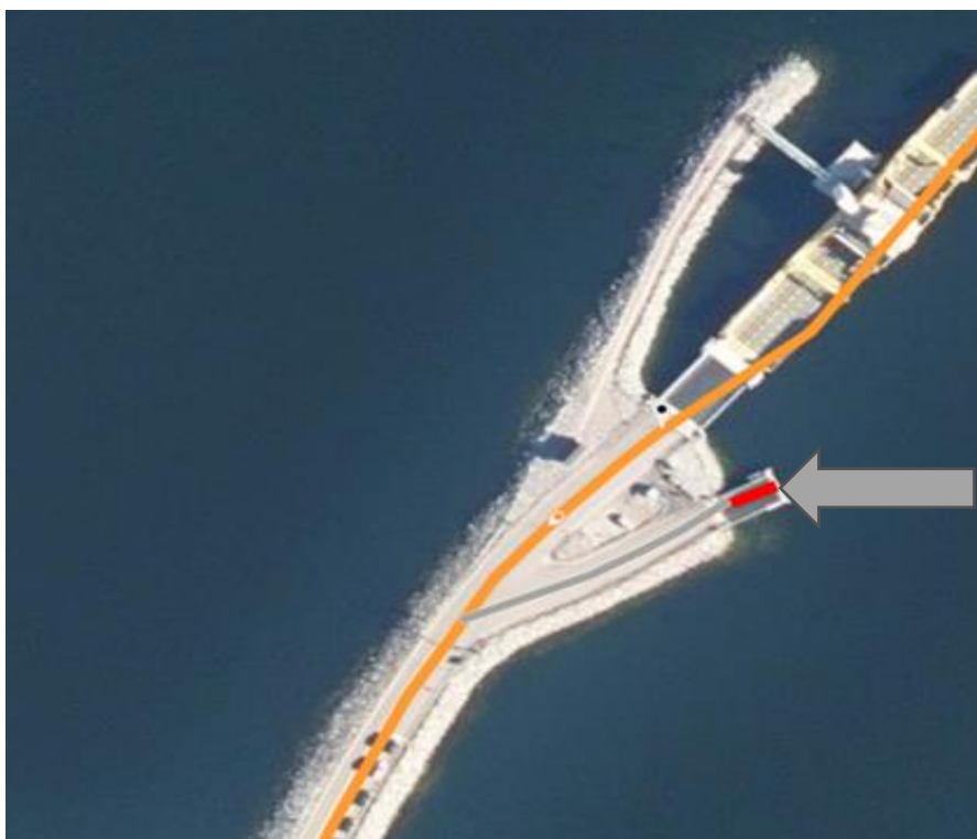
Kuva 43. Tien geometriaa jatketaan laiturin päähän asti, mikäli se ei jatku lauttaväylänä.
