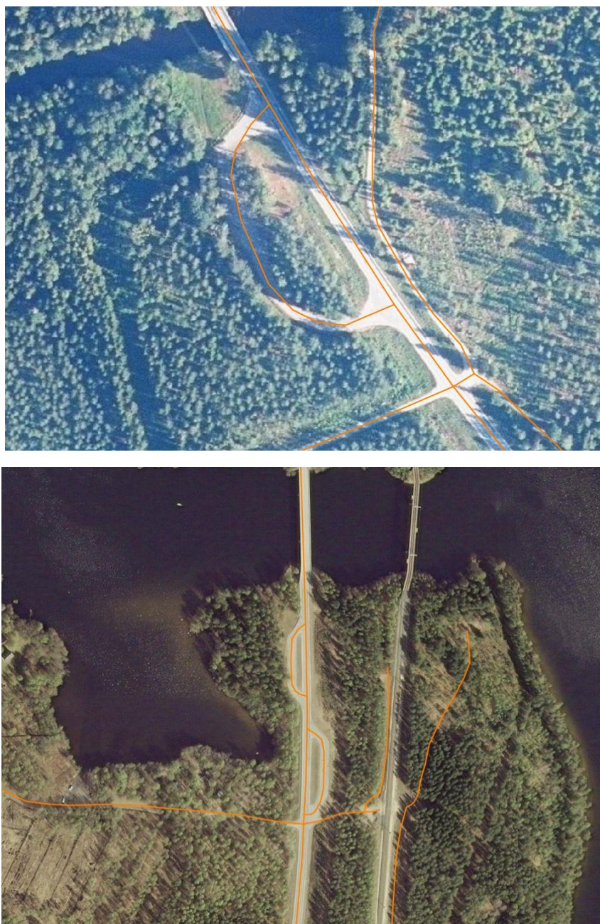
Kuva 37. Lenkki erottuu ajoväylästä fyysisellä esteellä. Lenkki mallinnetaan omana viivanaan.
