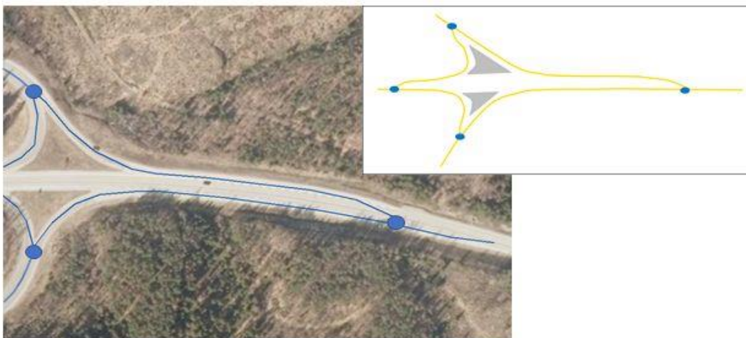
Kuva 15. Suuntaisliittymä ("kalanpyrstöramppi"): Haaraumien yhteydessä erkanemis- ja liittymiskaistojen keskilinjat kuvataan kuten muutkin rampit eli keskilinja alkaa kohdasta, josta ramppi maastossa fyysisesti alkaa.
