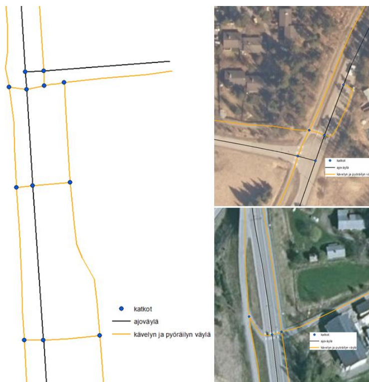
Kuva 7. Kävelyn ja pyöräilyn väylän yhteys muodostetaan suojatien kohdalle, mikäli pääväylän toisella puolellakin jatkuu kävelyn ja pyöräilyn väylä. Myös pysäkille muodostetaan oma yhteys (katso myös alla Kuva 9).
