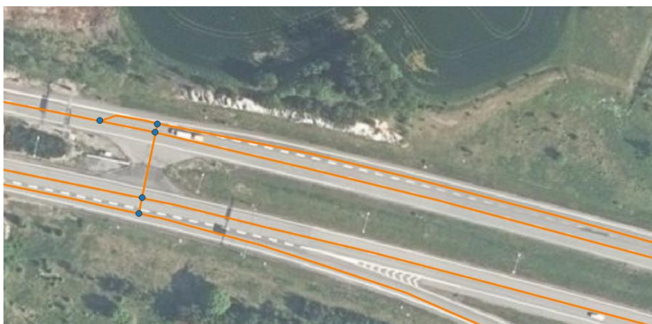
Kuva 35. Huoltoaukko yhdistetty myös rampin geometriaan.
