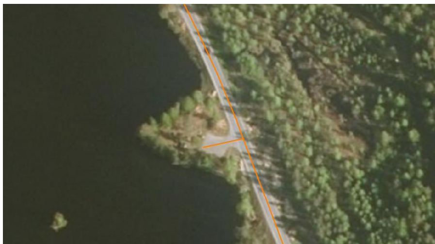
Kuva 41. T-mallin levikkeessä geometria mallinnetaan pistona ajoväylästä alueen päähän.
