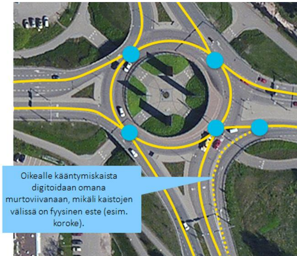
Kuva 23. Kiertoliittymä, jossa oikealle kääntyvät pääsevät ohittamaan kiertoliittymän (=vapaa oikea). Huom! kääntyvää kaistaa ei digitoida omana geometrianaan, mikäli kaistojen välissä ei ole fyysistä estettä.
