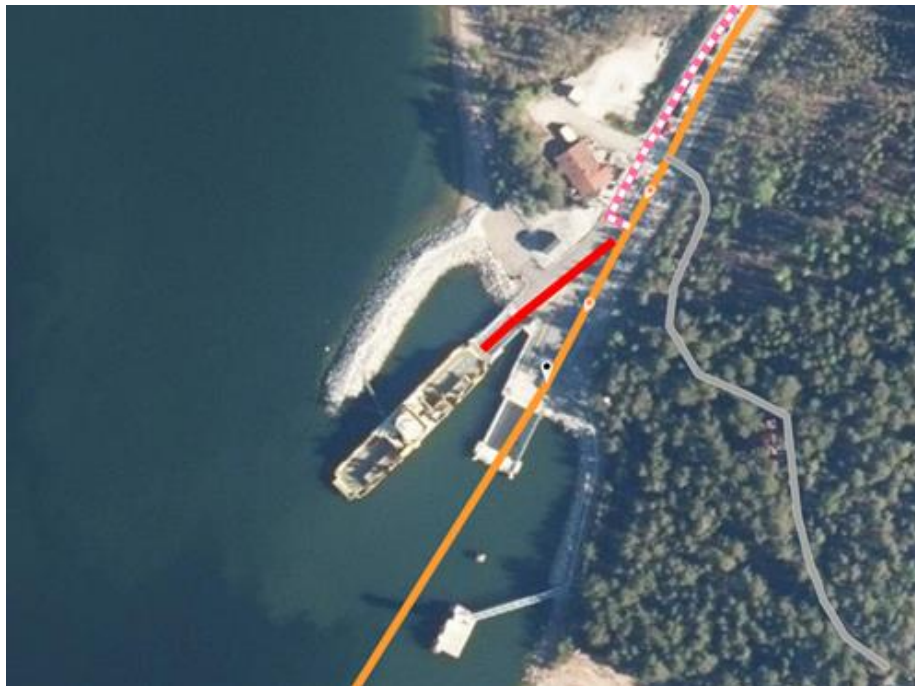
Kuva 45. Jos laituri on erillinen ja sinne johtaa oma tie niin sille tehdään oma geometria (haara). Kuvan erillisessä laiturissa lautta on kiinnittyneenä.
