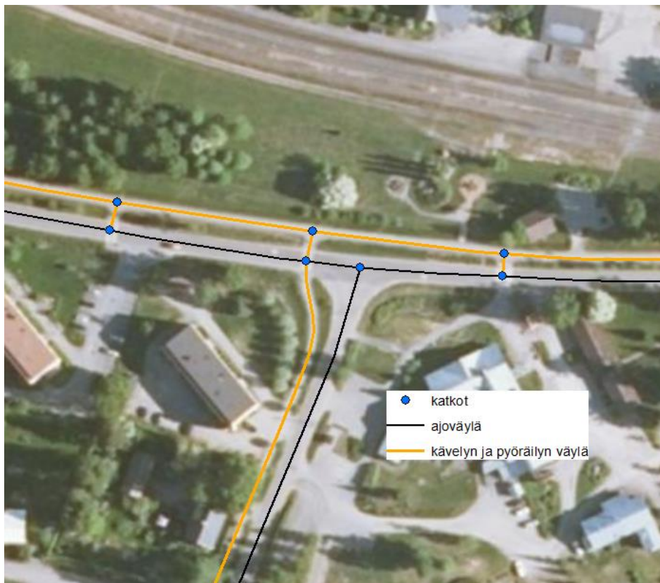
Kuva 9. Suojatien yhtymäkohdat tonteille tai pihoihin piirretään myös omana geometriana, mikäli kulkuyhteys erotuu erillisenä haarana.
