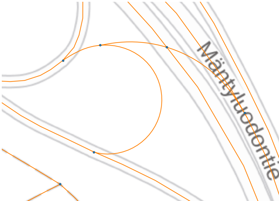
Kuva 45. Ainoastaan erikoiskuljetuksen käyttöön suunnitellut rampit mallinnetaan mukaan SURAVAGE aineistoon.
