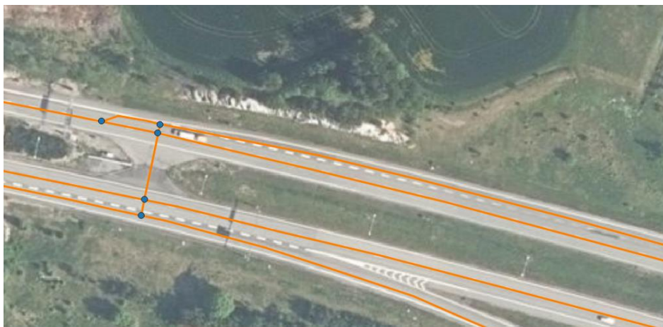
Kuva 33. Huoltoaukko yhdistetty myös rampin geometriaan.
