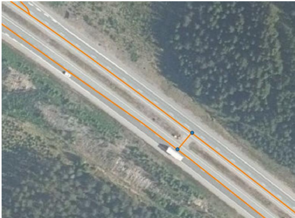
Kuva 32. Huoltoaukon geometria kuvattuna kaksisuuntaisena moottoritillä.
