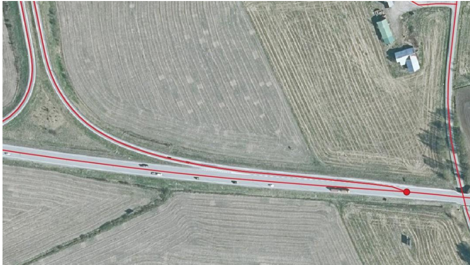
Kuva 9. Katko sijoitetaan liittymis- tai erkanemiskaistan päähän
