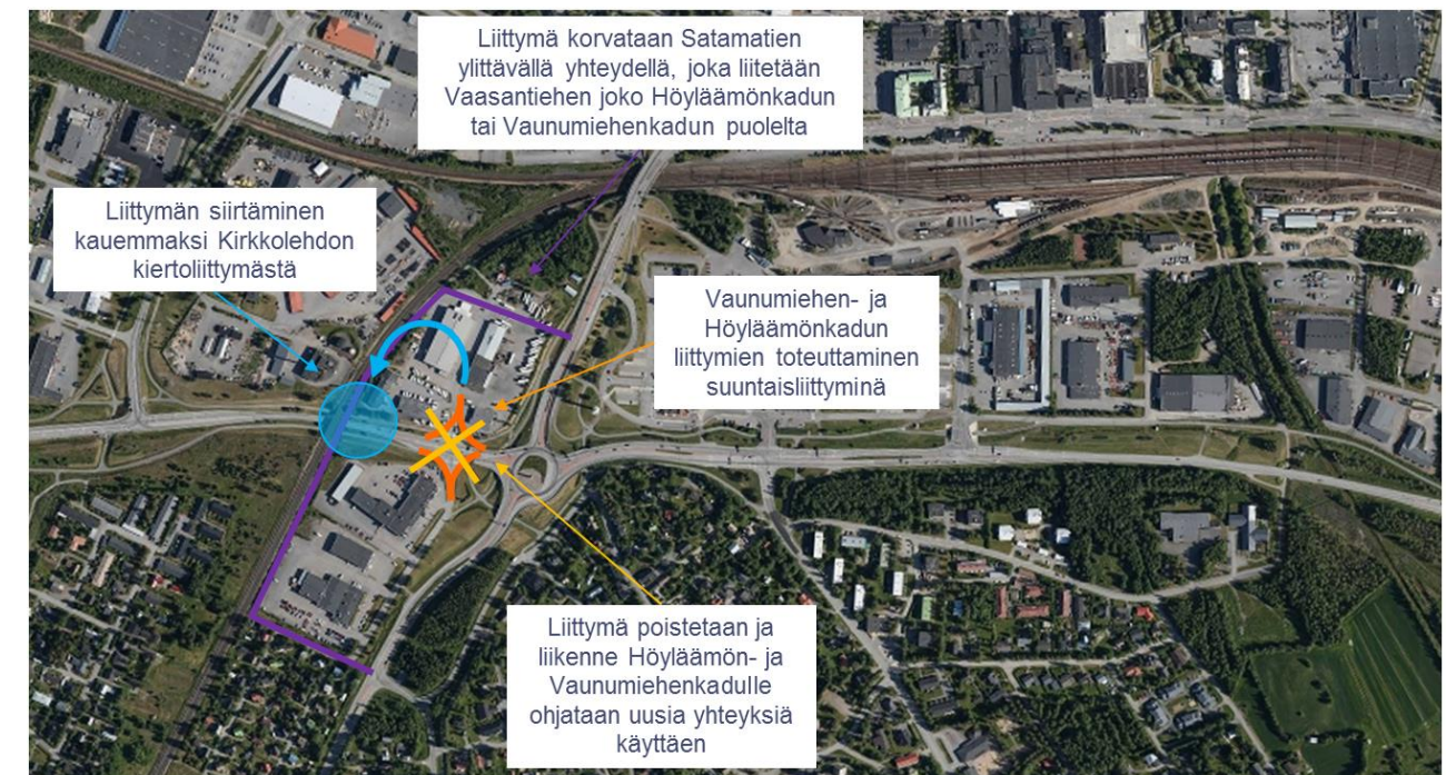
Kuva 12. Tutkitut Vaunumiehen- ja Höyläämönkadun liittymän vaihtoehtoiset ratkaisumallit
