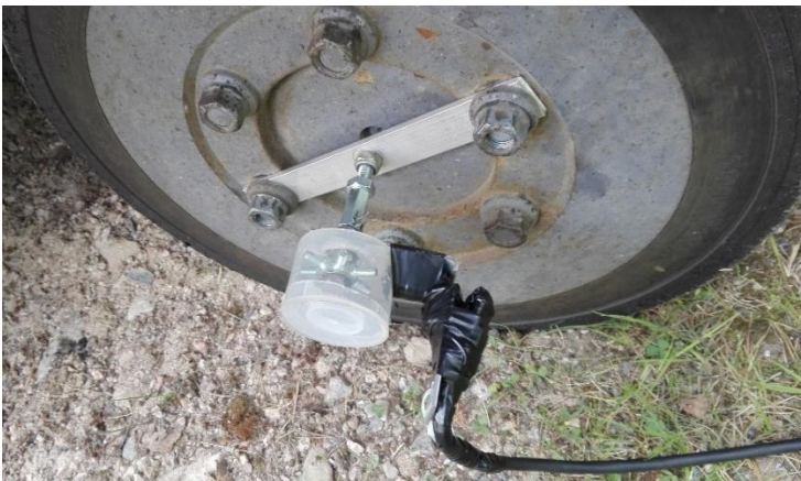
Kuva: Nopeusanturin kiinnitys levittimen eturenkaaseen
