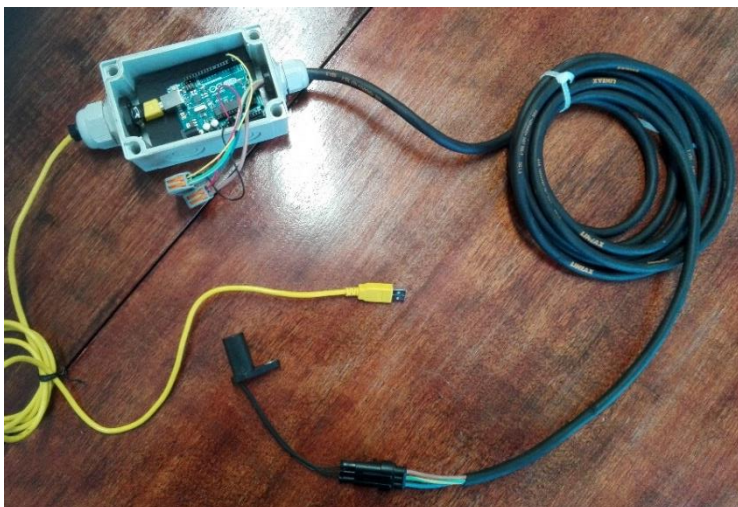
Kuva: Arduino Uno Mikro-ohjain ja Hall -anturikomponentti
