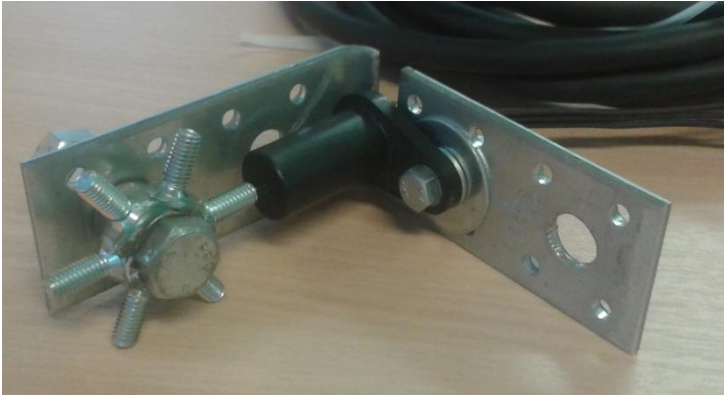
Kuva: Hall -anturikomponentti ja mittaussignaalin ratas
