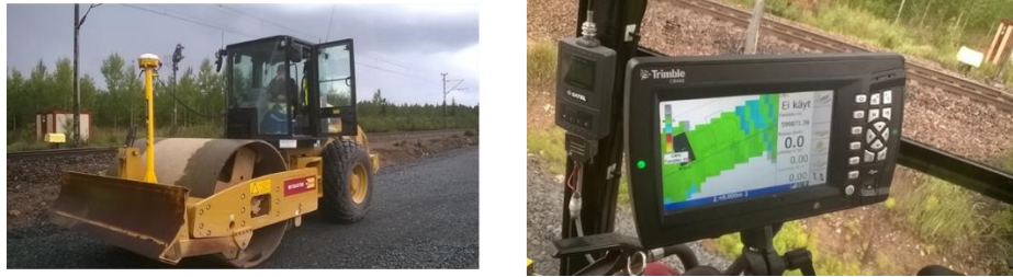
Kuva 1. Trimble CSC 900 jyrän tiiveydenseurantajärjestelmästä on kokemusta Riippa-Eskola RU2 projektilla toteutetussa pilotissa.
